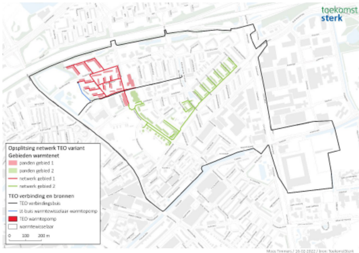
Figuur 7 Het warmtenet bestaat uit twee delen. In Gebied 1 worden gestapelde woningen van warmte voorzien en geïsoleerd. In het gebied staat ook een zorgflat, die een eigen net heeft, gevoed door één warmtebron. Ook de isolatie van de zorgflat is opgenomen in de businesscase. In Gebied 2 is een deel van de flats van woningcorporatie SWZ. In de businesscase wordt ook isolatie van die flats meegenomen.
